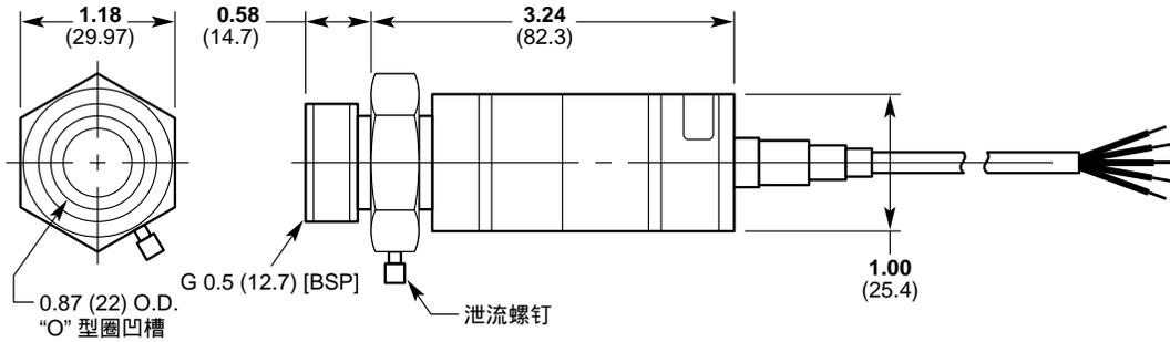
标准尺寸 (带泄流螺钉, 压力端口为1/2" BSP)
